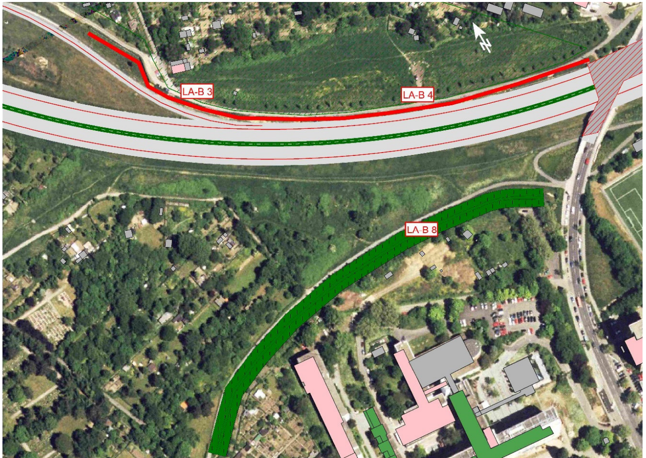
Abbildung 3 Übersicht der umgesetzten Lärmschutzmaßnahmen im Bereich "Katharinenkrankenhaus"[2]
