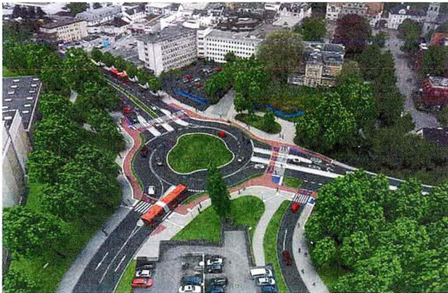
Beispiel Turbo-KV Bergisch Gladbach, umgesetzt vor ca. 1,5 Jahren Dargestellt: Fotomontage aus Bürgerportal 10.04.2017
