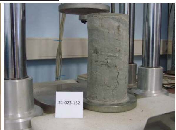
Probe nach Prüfung, Bruchbild Bruch auf Kluffflächen
