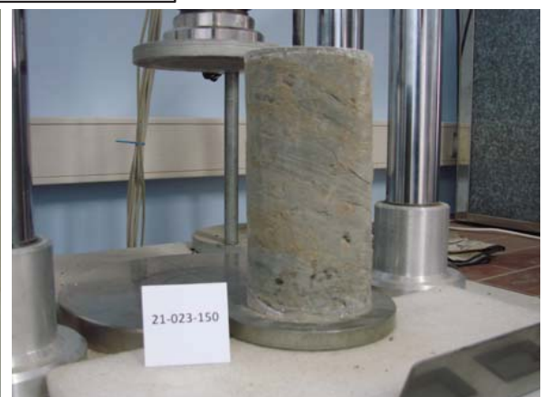
Probe nach Prüfung, Bruchbild Bruch auf ca. 45° geneigter Schichtfläche
