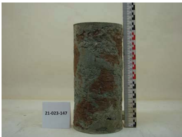
Probe vor Prüfung Versuch mit Wegregelung, konstante Verformungsgeschwindigkeit Endflächenabgleich mit Mörtel, da veränderlich festes Gestein
